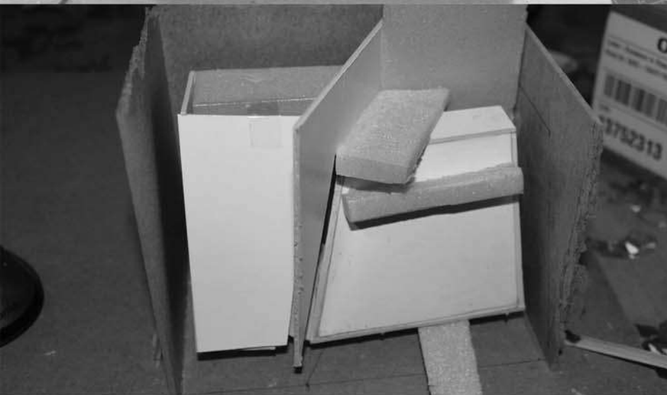
Herstellen der Negativ-Räume aus Pappe und Styrodur
