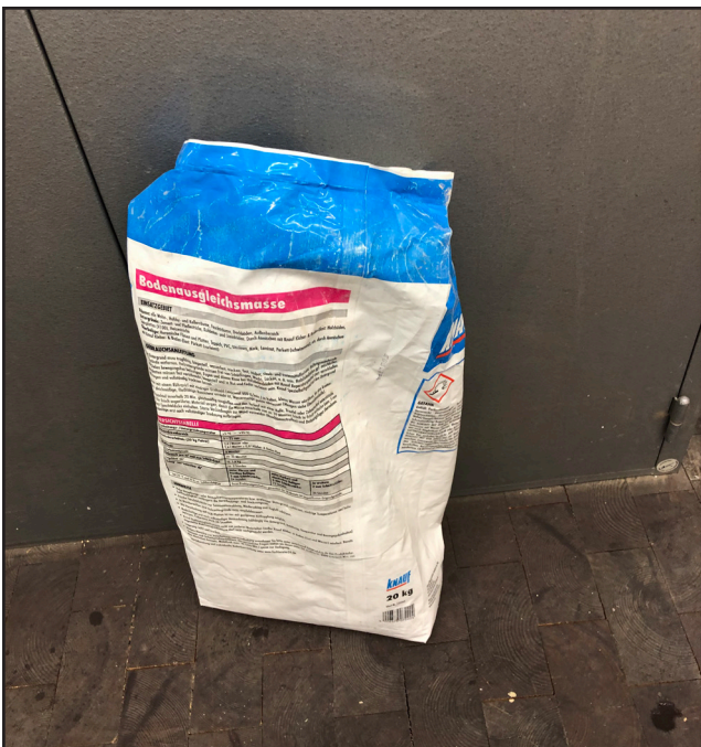
Schritt 11: Fussbodenausgleichsmasse nach dem Mischverhältniss des Herstellers anrühren.
