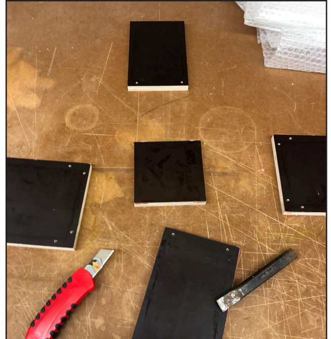
Schritt 4: Bau des Schalungskasten aus Siebdruckplatten. (Niedrige Wasserdurchlässigkeit)
