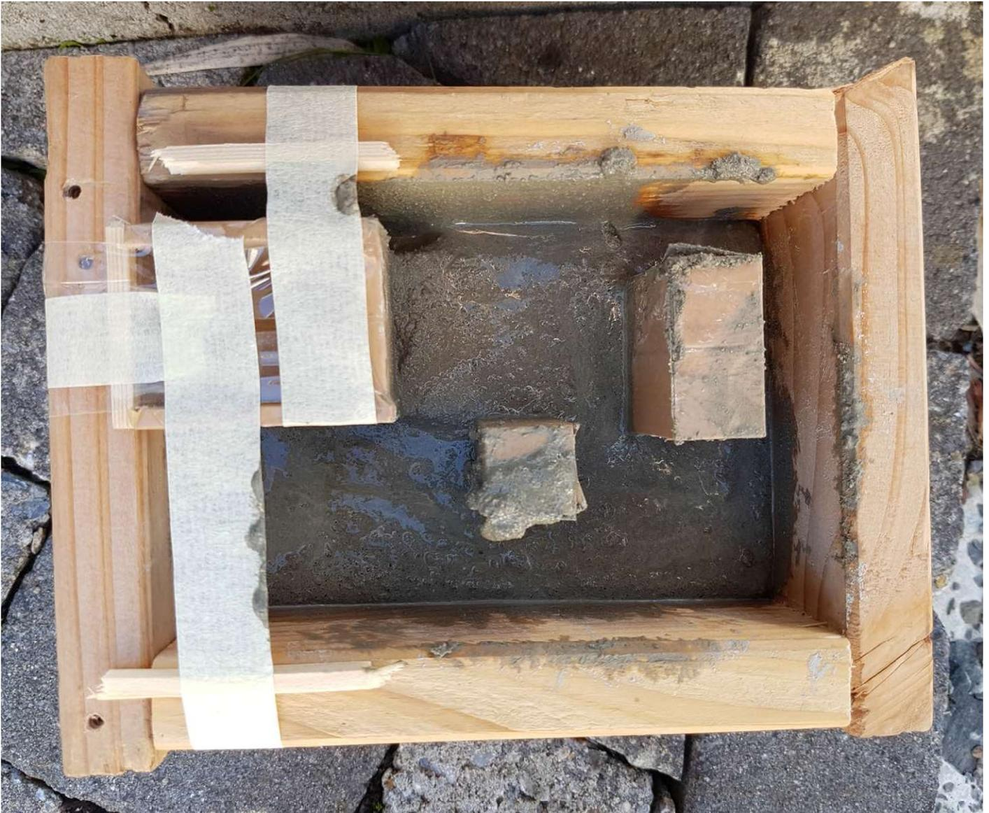
Der Beton wird langsam eingefüllt und zwischendurch durch Klopfen und Schwenken in alle Ecken verteilt.
